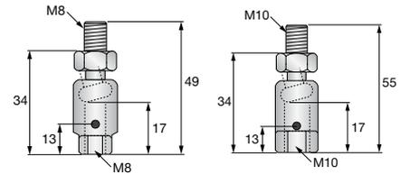
**Technische Daten** für Pendelabhängiger (schwere Ausführung) MPH
