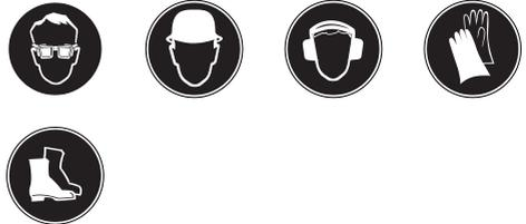
L'utilisateur et les personnes se trouvant à proximité pendant l'utilisation et toute intervention sur l'appareil doivent porter des lunettes de protection adaptées, un casque de protection, des chaussures de sécurité et un casque antibruit. L'utilisateur doit aussi porter des gants de protection.
