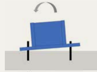
Fig. 3: Il momento di flessione genera una sollecitazione nel/nei tirante/i.
