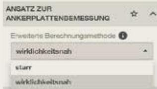
Die wirklichkeitsnahe Ankerplattenbemessung kann für statische und seismische Einwirkungen aktiviert werden. Unter der Registerkarte „Lasten“ finden Sie den „Ansatz für das Design der Ankerplatte“ und ändern ihn von starr (Annahme einer starren Ankerplatte) auf wirklichkeitsnah.
