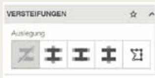
Sie können Versteifungen auswählen und positionieren, um die Steifigkeit Ihrer Ankerplatte zu erhöhen. Es gibt 3 verschiedene vordefinierte Versteifungspositionen.
