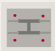
Fügen Sie Versteifungen hinzu, um die Steifigkeit der Ankerplatte zu erhöhen.
