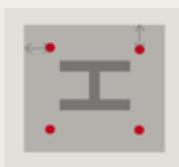
Reduzierung des Abstandes zwischen Dübel und Kante der Ankerplatte (reduzierte Plattengröße).
