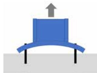
Abb. 4: Abstützkräfte in der Nähe der Kanten
