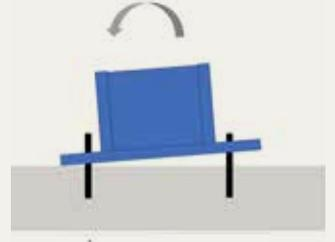
Abb. 3: Das Biegemoment erzeugt Spannung in dem/den Anker(n).
