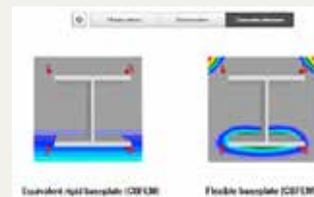
Abb. 10: Vergleich der Druckzone
