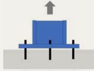
Abb. 2: Zuglast wird gleichmäßig auf alle Dübel verteilt
