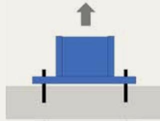
Abb. 1: Zuglast wird gleichmäßig auf alle Dübel verteilt
