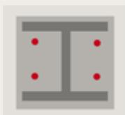
Erhöhen Sie die Größe des Profils und verbessern Sie das Profil-Ankerplatten Verhältnis.
