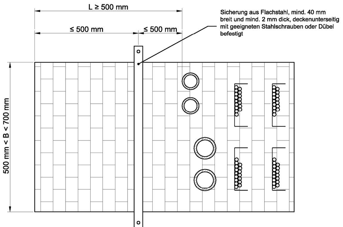
Feuerwiderstandsfähige Abschottung für elektrische Leitungen und/oder Rohrleitungen aus Kunststoff oder Metall "Hilti Brandschutz-System CFS-BL P Kombi S 90"
