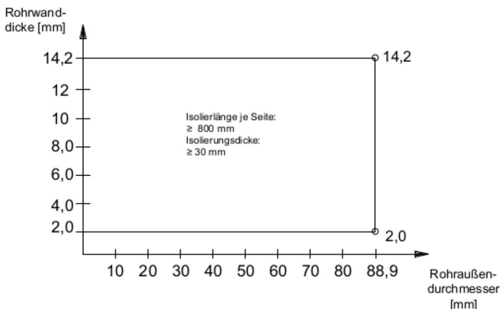
Feuerwiderstandsfähige Abschottung für elektrische Leitungen und/oder Rohrleitungen aus Kunststoff oder Metall "Hilti Brandschutz-System CFS-BL P Kombi S 90"
