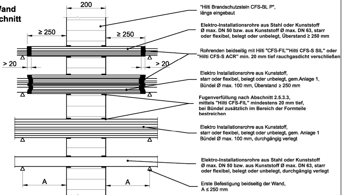
Rohrenden mit Hilti "CFS-FIL" / "Hilti CFS-S SIL" oder "Hilti CFS-S ACR" min. 20 mm tief rauchgasdicht verschließen
