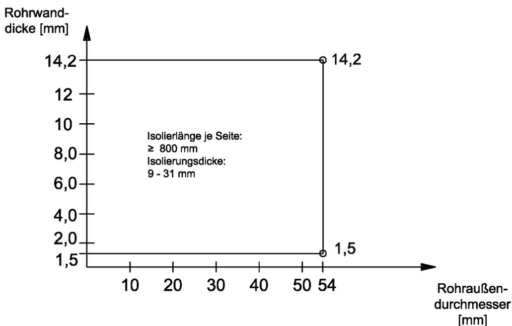
Feuerwiderstandsfähige Abschottung für elektrische Leitungen und/oder Rohrleitungen aus Kunststoff oder Metall "Hilti Brandschutz-System CFS-BL P Kombi S 90"
