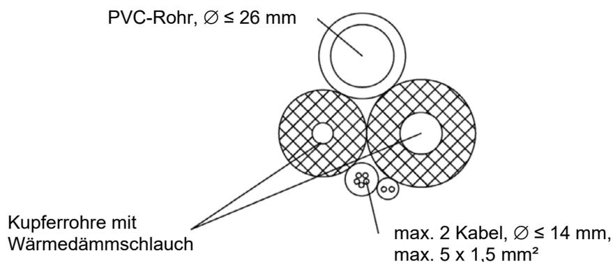
Feuerwiderstandsfähige Abschottung für elektrische Leitungen und/oder Rohrleitungen aus Kunststoff oder Metall "Hilti Brandschutz-System CFS-BL P Kombi S 90"
