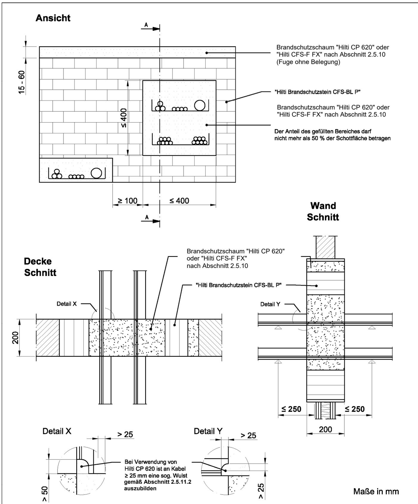
Feuerwiderstandsfähige Abschottung für elektrische Leitungen und/oder Rohrleitungen aus Kunststoff oder Metall "Hilti Brandschutz-System CFS-BL P Kombi S 90"
