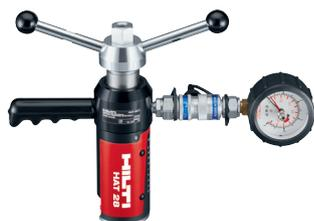
Das beschriebene Produkt ist ein spezifisches System zum Testen von Bolzen. Es besteht aus einer mechanischen Buchse, die durch eine hydraulische Lastzelle verläuft und die auf den Bolzen ausgeübte Last direkt misst.
