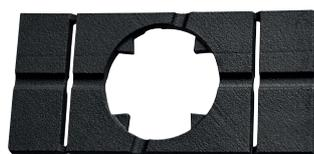
Stützplatten sind optional erhältlich, um die Lastverteilung für F-BT-MR SN-Bolzen mit Dichtscheiben zu unterstützen. Die Platte wird an der Basis des Bolzens um die Unterlegscheibe herum installiert, um eine ebene Oberfläche für das befestigte Material zu schaffen. Dies hilft, Biegemoment-Effekte auf das Basis- oder Ausgangsmaterial zu übertragen.
