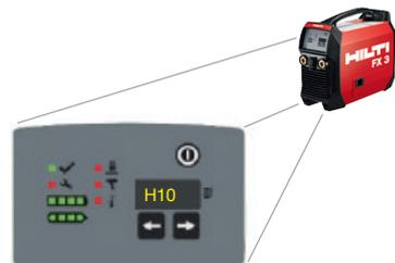
Das Hilti-FX-3 Gerät verfügt über eine integrierte Verfahrenskontrolle, die hilft, Fehler vor, während oder nach dem Schweißvorgang zu erkennen. Ein Fehler wird durch einen F-Code auf der Anzeige des Geräts angezeigt.
