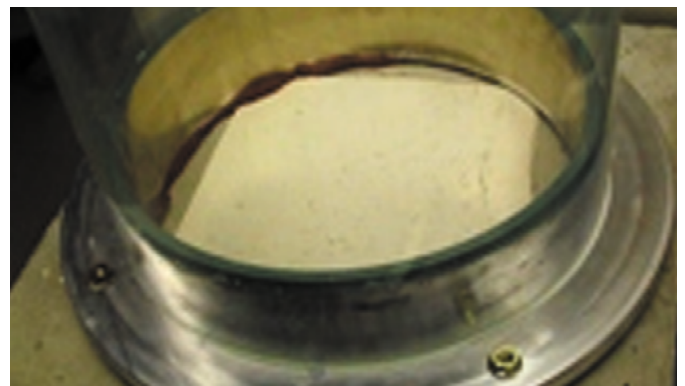
CFS-S SIL mit Flansch und Plexiglasrohr montiert.
