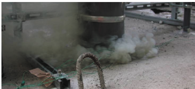
Rauchentwicklung bei einem unzureichend abgeschotteten Kunststoffrohr im Brandversuch nach 8 Minuten.
