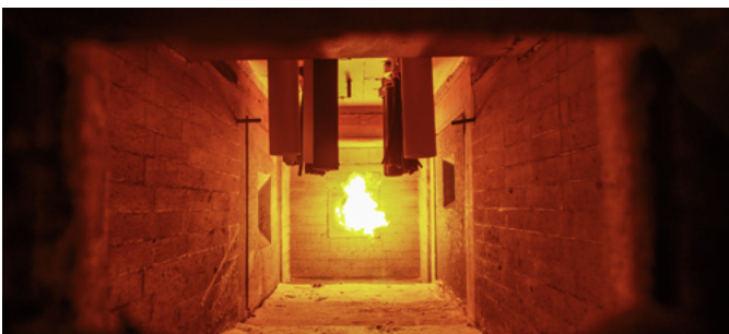
Brandtestofen im Hilti Forschungs- und Technologiecenter.
