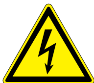
Nebezpečí úrazu elektrickým proudem
